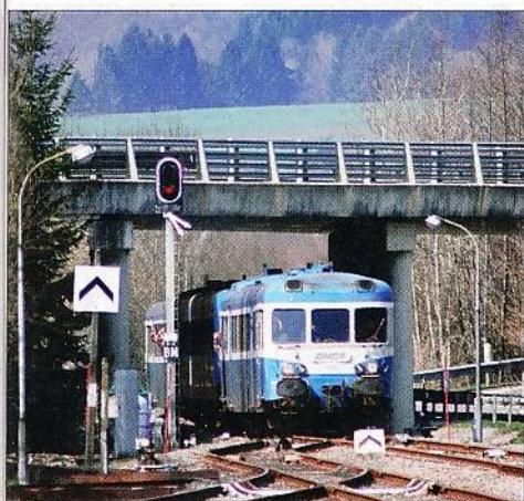
Le chevron pointe en haut s'utilise à la sortie des voies de service ou de gare. Il indique au mécanicien que plusieurs voies sont commandées par le même signal.
