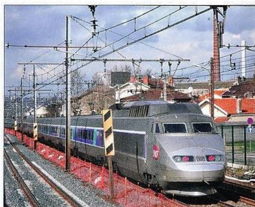
Ces panneaux sont dénommés "mirlitons". Ils sont implantés en amont d'un signal dont la visibilité est réduite. Il y en a 3, le premier est placé à 300m du signal concerné, 100m séparent chaque mirliton.
