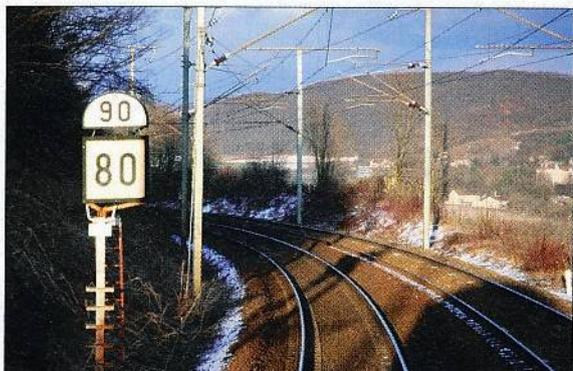
Ce signal de forme semi-circulaire, dit TIV de type C, ne concerne que les autorails et les rames automotrices et limite leur vitesse à 90 km/h. Il peut être utilisé seul ou avec un tableau d'annonce ordinaire: 80 km/h pour tous les autres trains.
