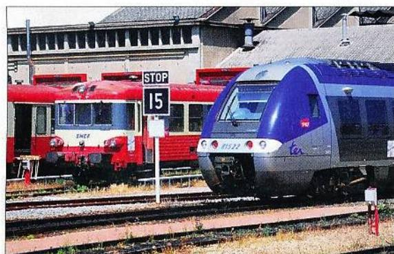
Comme sur la route, le "STOP" se rencontre le long des voies. Le mécanicien doit marquer l'arrêt puis franchir la pancarte si rien ne s'y oppose. Voici un exemple sur une voie d'entrée du dépôt d'autorails de Lyon-Vaise.
